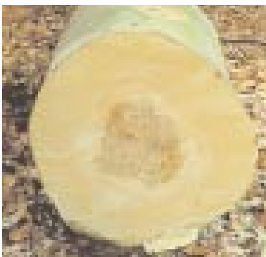
Abb. 1: Buchenstamm mit Rotkernbildung im zentralen Bereich
