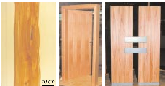
Abb. 3: Beispiele für die dekorative Verarbeitung von rotkernigem Buchenholz. Links: Buchenbrett mit farblich ausgeprägtem Rotkern Mitte: Türblatt aus rotkernigem Buchenfurnier Rechts: Fronten aus rotkernigem Buchenholz für Designermöbel
