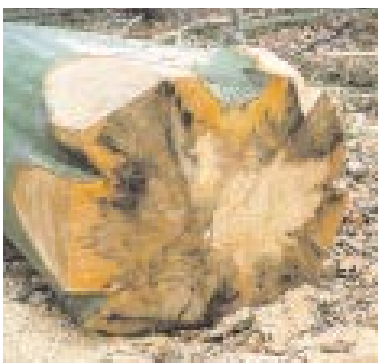
Abb. 2: Buchenstammabschnitt mit ausgeprägter Spritzkernbildung und gleichzeitiger Infektion durch Bakterien
