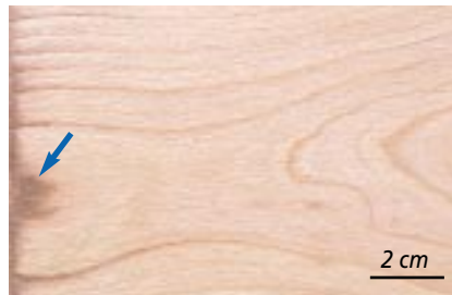
Abb. 7: Anreicherung von farbgebenden Inhaltsstoffen an der Holzoberfläche eines getrockneten Buchenbrettes
