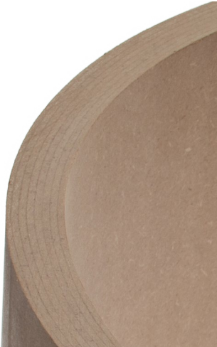
durchgehender Holzwerkstoff - Aufbau
