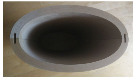
Ausführung in MDF mit genuteten Längskanten
