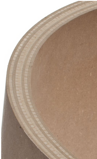
komibierter Holzwerkstoff / Sperrholz - Aufbau
