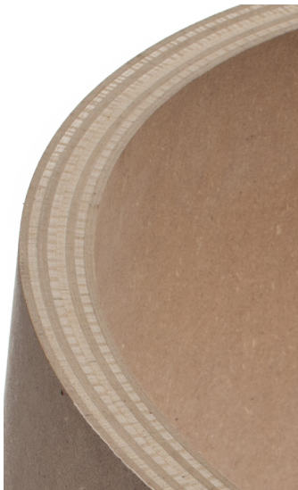
komibierter Holzwerkstoff / Sperrholz - Aufbau
