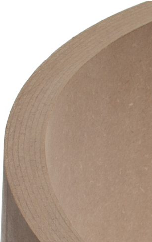
durchgehender Holzwerkstoff - Aufbau
